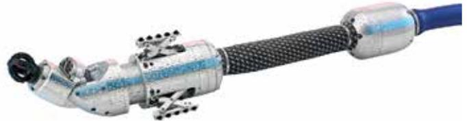
Der manuelle Vorschub zur Einsatzstelle wird unterstützt durch eine HD-Wasserstrahlfunktion, einzeln ansteuerbare Wasserdüsen am Gehäuseumfang sind die Basis für das zielgenaue Abbiegen in Seitenanschlüssen.
