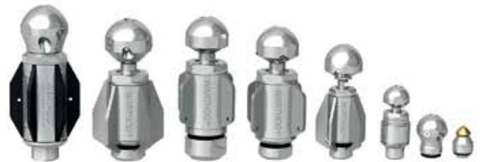
WARTHOG Düsen wurden bereits 1997 mit großem Erfolg im amerikanischen Markt eingeführt. Diese kontrolliert rotierenden Düsen setzen die gelieferte Wasserenergie zu 100 % ausdrücklich nur im Düsenkopfbereich sowohl für den Vortrieb als auch für die Reinigungsleistung um und sind somit die kraftvollsten Rotierdüsen, die für Entfernung von Wurzeln, mineralischen Ablagerungen und zur Vorbereitung für die Kanalinspektion sowie Kanalinstandsetzung eingesetzt werden können.
