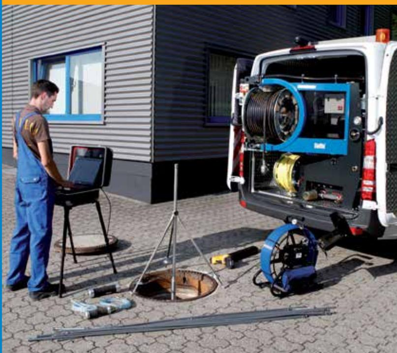
In Verbindung mit handelsüblichen Absperreinrichtungen ist sie in der Lage, die Dichtigkeit von Öl-, Benzin-, Fettabscheidern jeglicher Dimension sowie Schächten, Kläranlagen und Abwasserrohren zu prüfen.
