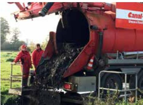
Nach Fertigstellung der Reinigung zeigte die Waage ein Gesamtergebnis von insgesamt 240 t aus der Druckrohrleitung gereinigte Kanalsande.
