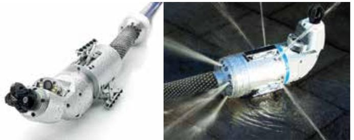
Endloskreisen, Arm heben/senken und der axiale Vorschub von 50 mm werden elektrisch betrieben, ebenso wie die zentrische Verspannung im Rohr bzw. Liner.
