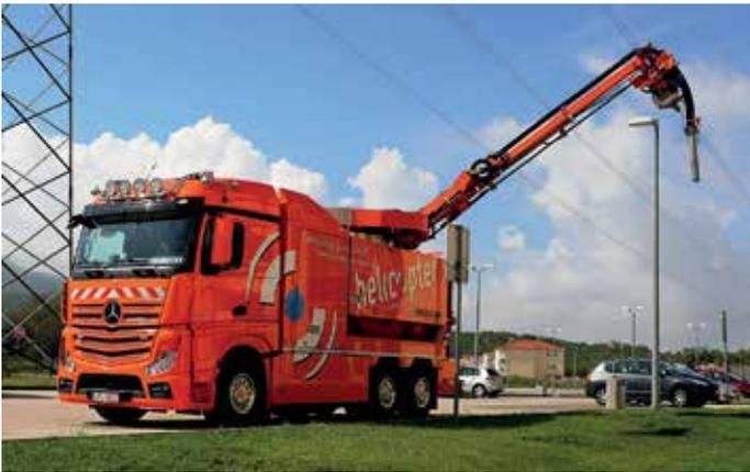
Die Einzigartigkeit dieses Fahrzeuges besteht in dem von MÜLLER entwickelten Tandemausleger, der in Anlehnung an einen Helikopter den Namen HELI 360-6 Tandem trägt. Beim HELI 360-6 Tandem MONO HD erfolgt die Führung des Saug- und Spülschlauches über einen Ausleger, der um 360° schwenkbar, um 30° anhebbar und um 10° absenkbar ist. Darüber hinaus ist der Ausleger bis auf ca. 7250 mm teleskopierbar.
