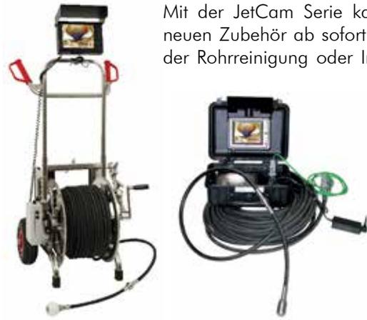
Mit der JetCam Serie kann mit diesem neuen Zubehör ab sofort noch besser in der Rohrreinigung oder Inspektion gearbeitet werden. Hindernisse sind nun nicht mehr unbedingt das „Aus“ bei einer Befahrung, andererseits kann nun mit der Vorstrahldüse noch besser und vor allem zielgerichtet gereinigt werden.
