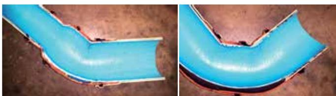
Flexi SF Tube DN 125 mit Nennweitenübergang auf DN 150 mit 45°-Bogen und mit 90°-Bogen, ohne Kalibrierschlauch ausgehärtet d. h. Dampf direkt auf der Beschichtung.
